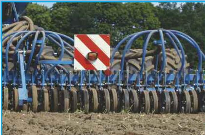
Распределители семян расположены снаружи семенного бункера, непосредственно над сошниковым брусом. Для точного распределения семенные шланги, идущие от распределителя к сошнику, максимально короткие и имеют одинаковую длину. Плавное наклонное расположение семенных шлангов предотвращает забивания. Распределитель легко открывается с целью контроля. При помощи поставляемого вместе с орудием шланга для опустошения, бункер можно быстро опустошить через распределитель.
