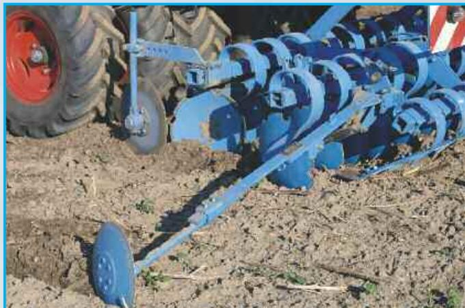
Гидравлические следоуказатели расположены далеко спереди и всегда находятся в поле зрения водителя. При этом они, естественно, оснащены срезными болтами. Благодаря этому не происходит серьезных повреждений при столкновении с препятствиями.
