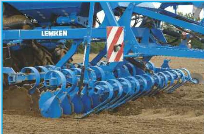
Если Компакт-Солитэр<sup>plus</sup> работает по вспаханной поверхности, рекомендуется установка гидравлически регулируемых планировочных зубьев. Они надежно выравнивают колею от колес и, если в них нет необходимости, могут подниматься при помощи гидровыхода двойного действия из кабины трактора.
