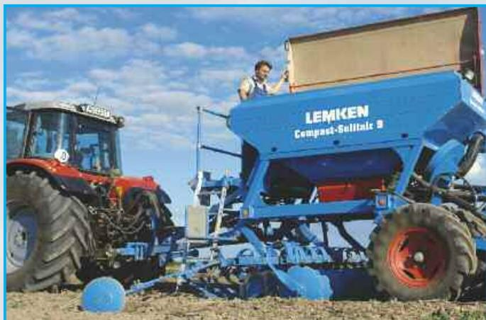
Доступ к семенному бункеру большого объема осуществляется спереди по левую сторону орудия. Данное расположение обеспечивает короткий путь из кабины трактора для снижения затрат времени при заполнении. Лестница и площадка изготовлены из не скользкого материала. Поручни относятся к базовому оснащению, так как безопасность для ЛЕМКЕН имеет первостепенную важность.
