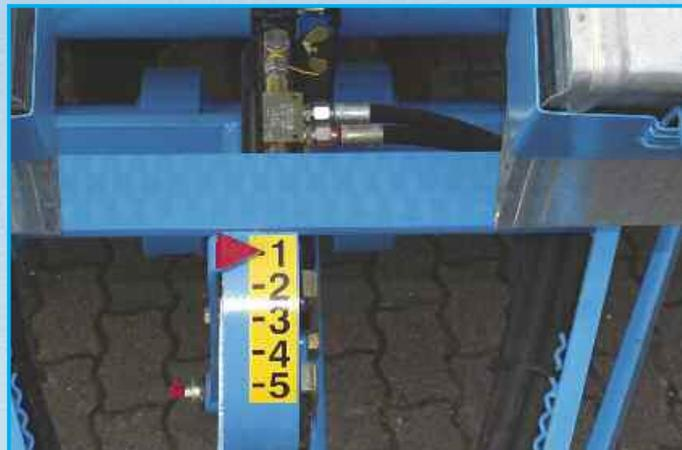
Для посева при изменяющихся почвенных условиях и на ограниченных пространствах рабочие секции Компакт-Солитэр<sup>plus</sup> ЛЕМКЕН серийно оснащаются гидравлической регулировкой глубины обработки. Таким образом, глубина обработки может удобно и просто изменяться из кабины трактора. Хорошо читаемая шкала всегда показывает актуальные настройки.
