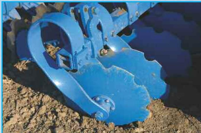
Крайние полусферические диски рабочих секций можно регулировать по высоте, для того чтобы во всех почвенных условиях обеспечить равномерность подготовки почвы под последующий посев. У не складываемых версий Компакт-Солитэр<sup>plus</sup> наружные диски складываются. Таким образом, при ширине захвата три метра, выдерживается также транспортная ширина в три метра.
