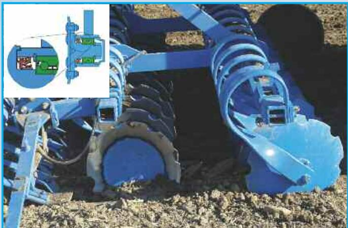
На опорах рабочих секций дополнительной защитой от скручивания служит корпус подшипника специальной формы. Для точного выдерживания заданной глубины каждый диск отдельно закреплен на раме при помощи пружины. Пружины гарантируют значительно большую стабильность ведения дисков, чем при применении резиновых демпферов. Одновременно с этим, пружины также служат автоматической защитой от перегрузок.
