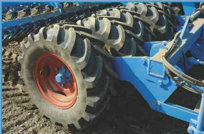
Компакт-Солитэр<sup>plus</sup> ЛЕМКЕН оснащена шинным катком-уплотнителем диаметром 1.097 мм, при помощи которого посевной горизонт равномерно уплотняется, для чего требуется значительно меньше тяговой силы по сравнению с другими универсальными сеялками. Шины размером 420/65 R20 (опция) позволяют снизить давление в шинах всего до 0,8 бар. Благодаря этому посев может осуществляться даже во влажных почвенных условиях.
