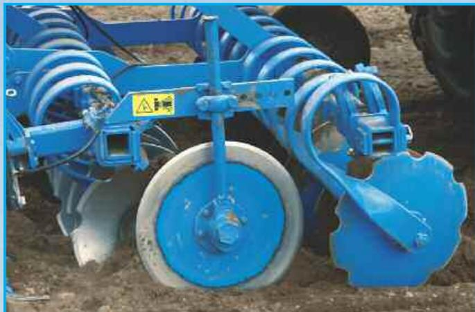
Компакт-Солитэр<sup>plus</sup> оснащена секцией рабочих органов короткой дисковой бороны Гелиодор ЛЕМКЕН. Данная секция состоит из двух рядов отдельно навешенных, вырезных полусферических дисков, которые, обладая диаметром 465 мм и толщиной 5 мм, особо устойчивы к износу. Положение дисков способствует хорошему заглублению. Для интенсивной обработки при высокой скорости посева диски Гелиодора расположены в два ряда со смещением по отношению друг к другу и имеют шаг следа 125 мм.
