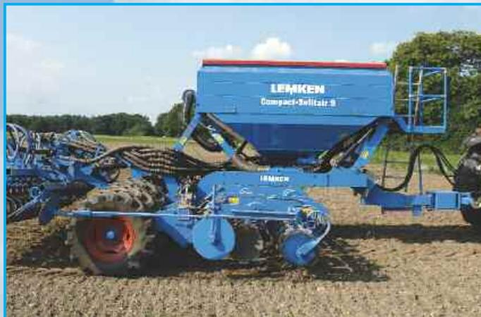
Для транспортировки по дорогам перед складыванием посевной комбинации большой семенной бункер смещается на один метр вперед. Благодаря этому для больших колес Компакт-Солитэр<sup>plus</sup> остается достаточно места позади семенного бункера. Таким образом, ЛЕМКЕН достигает идеального распределения веса и выдерживания транспортной ширины три метра.
