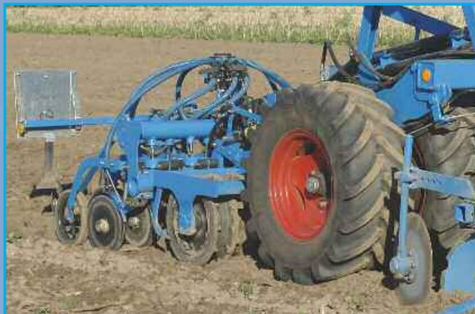
Для определенного предварительного уплотнения посевных рядов непосредственно перед двухдисковыми сошниками ОптиДиск Компакт-Солитэр<sup>plus</sup> может дополнительно оснащаться трапециевидальным катком. Каток улучшает, как плавность работы сошников, так и контакт семян с почвой. Гидравлическая регулировка давления катка осуществляется бесступенчато.
