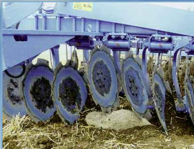
При контакте с препятствиями, такими как камни, полусферические диски независимо друг от друга могут отклоняться вверх. Спиральные пружины служат для того, чтобы, после преодоления препятствия, полусферические диски быстро возвращались в рабочее положение. Одновременно с этим, предварительно натянутые стабильные спиральные пружины, даже на твердых почвах, обеспечивают более точное выдерживание рабочей глубины, чем это возможно с более мягкими резиновыми элементами.
