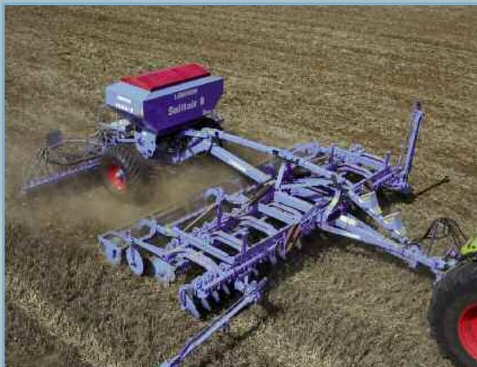
Благодаря оснащению устройством навешивания, является возможным агрегатирование Рубина с пневматической сеялкой Солитер 9 фирмы ЛЕМКЕН.
