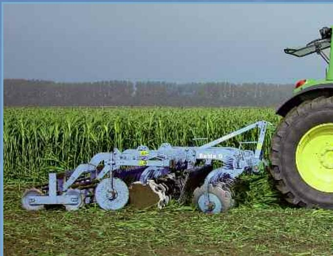
Диски Рубина фирмы ЛЕМКЕН расположены в ряду на расстоянии 250 мм. Это обеспечивает работу без забиваний. Поскольку задний ряд дисков расположен со смещением по отношению к переднему, образуется шаг следа шириной 125 мм.
