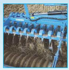
Рама короткой дисковой бороны Гелиодор отличается открытостью конструкции с большим просветом. Благодаря этому исключаются забивания. Короткая и компактная конструкция с выгодным расположением центра тяжести делает возможной также применение тракторов с меньшей тяговой силой. Применение высококачественной стали гарантирует высокую стабильность и долгий срок эксплуатации.
