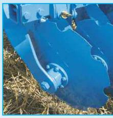
Специальная форма корпуса подшипника служит надежной защитой опоры диска. Для точного выдерживания глубины каждый диск отдельно закреплен на раме пружиной. Это гарантирует во время работы значительно большую стабильность ведения дисков, чем при применении резиновых демпферов. Одновременно с этим, пружины также служат автоматической защитой от перегрузок.
