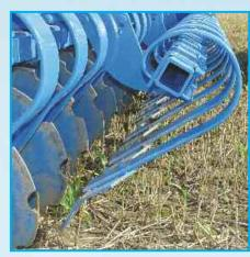
В качестве дополнительного оборудования спереди или сзади полусферических дисков могут применяться пружинные планировочные зубья шириной 150 мм. Они обеспечивают, особенно после работы плуга, оптимальное выравнивание посевного ложа. Угол установки выравнивающих зубьев и соответственно направление земельного потока к полусферическим дискам или каткам удобно регулируется из кабины трактора при помощи гидравлики.
