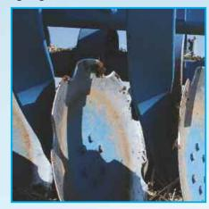
Гелиодор состоит из двух рядов, навешенных единично, вырезных полусферических дисков, которые имеют диаметр 465 мм и толщину 5 мм, благодаря чему они особо устойчивы к износу. Расположение дисков способствует хорошему заглублению в почву. Диски бороны Гелиодор ЛЕМКЕН расположены на расстоянии 250 мм двумя, смещенными по отношению друг к другу, рядами. Изза этого образуется шаг следа равный 125 мм, что делает возможной интенсивную обработку почвы.
