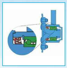
Не требующие обслуживания высококачественные аксиальные упорные шариковые подшипники обеспечивают бесперебойную, долговечную работу дисков. Подшипник надежно перенимает не только аксиальные, но и радиальные нагрузки полусферических дисков. Надежное лабиринтное уплотнение не дает пыли и грязи никаких шансов.
