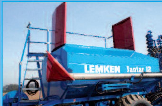
Доступ к семенному бункеру осуществляется просто и безопасно по не скользким ступеням с удобными поручнями. Через весь бункер проходит широкий помост, который также обеспечивает безопасный доступ к семенному бункеру. Таким образом, очистка при смене семенного материала происходит быстро. Раздельные крышки бункера открываются очень удобно. При работе они надежно закрывают бункер и защищают семена от пыли и загрязнений.
