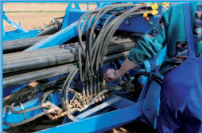
Для обеспечения управления на краю поля, посевная комбинация требует наличия трех гидровыходов двойного действия. Таким образом, следоуказатели могут приводиться в действие независимо от функции подъема секций Гелиодора и подъема сошников бруса. Четвертый гидровыход обеспечивает по выбору работу пневмотурбины или загрузочного шнека.
