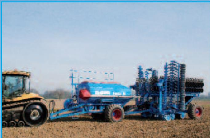
Пневматический посевной комплекс высокой производительности от ЛЕМКЕН для транспортировки с поля на поле обладает транспортной шириной 4,5 метра. Общий агрегат, состоящий из сеялки Янтарь 12 и полунавесного почвообрабатывающего орудия Гелиодор 12 DS с сошниковым брусом для семян и удобрений, имеет общую длину около 16 метров. Для комфортной транспортировки и соответственного щадящего воздействия на почву во время работы применяются широкие шины размером 700/50-30.5.
