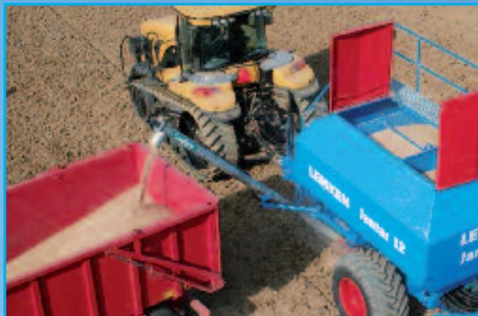
Поскольку при загрузке именно нефасованных семян и/или удобрений невозможно точно оценить загруженное количество, фирма ЛЕМКЕН разработала практичное решение проблемы. Загрузочный шнек может просто переворачиваться благодаря расположенной по центру точке поворота и поворотному подшипниковому узлу таким образом, что все бункеры могут также легко опустошаться. Поэтому возможно осуществление, как загрузки, так и опустошения бункеров с одинаковой производительностью в 400 кг в минуту.
