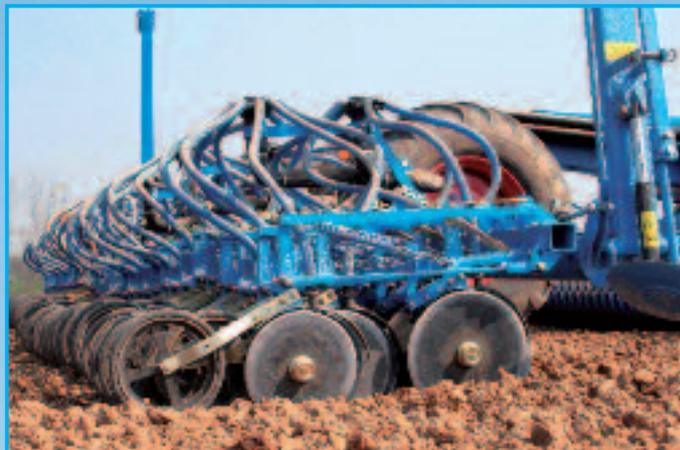
Расположенные на параллелограммной раме двухдисковые сошники делают возможной независимую друг от друга регулировку давления сошников и глубину заделки семян. Диски предусмотрены с устойчивыми к износу и не требующими обслуживания радиальными шариковыми подшипниками. Стабильные уплотнительные крышки защищают подшипник от загрязнений. Пространство между дисками полностью защищено уплотнителем. Таким образом, блокирование камнями и другими инородными предметами исключено.
