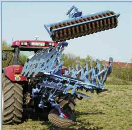
Интегрированный уплотнитель ФиксПак имеет постоянное соединение с плугом при транспортировке по дорогам и при развороте на меже. Таким образом, нет необходимости делать отдельно из-за уплотнителя при транспортировке дополнительную ходку. Даже проблемные поля, имеющие клинья или препятствия можно обрабатывать без проблем. ФиксПак применяется с плугами как с механизмом защиты от камней, так и без него.
