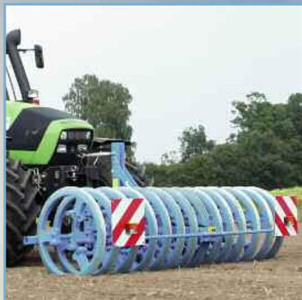
ВариоПак во фронтальной навеске уплотняет почву, благодаря чему колеса трактора не проваливаются и между колесами не образуются гребни. Таким образом, он обеспечивает наилучшие условия для получения точно и равномерно подготовленного посевного ложа. При этом следующие позади орудия, могут работать более мелко, так как больше не нужно устранять колею трактора. Фронтальный однорядный кольцевой уплотнитель (FEP) отличается компактным исполнением и особенно выгодным расположением центра тяжести.
