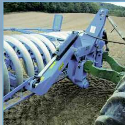
Интегрированное механическое устройство управления работает над местом соединения, расположенным перед уплотнителем, таким образом, что обеспечивается надежная работа в сцепке и управление по всей длине контура поля. FEP поставляется с кольцевым полфилем диаметром 700 мм или 900 мм.
