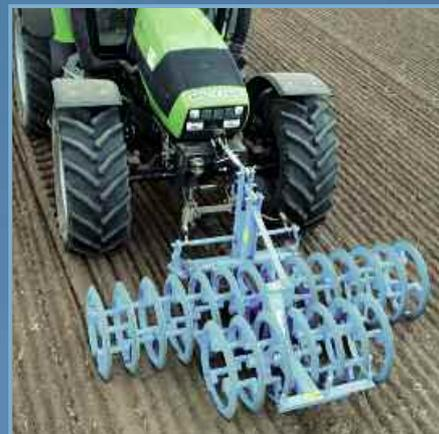
Только сменный двухрядный уплотнитель (WDP) от ЛЕМКЕН предлагает возможность работы с различной шириной захвата. В области оси трактора, которая не прикапывается колесами, работают двоянные кольца уплотнителя. Во фронтальной области колес трактора одинарными кольцами уплотнителя и колесами трактора также достигается хорошее уплотнение. Это является предпосылкой для получения равномерного посевного ложа.
