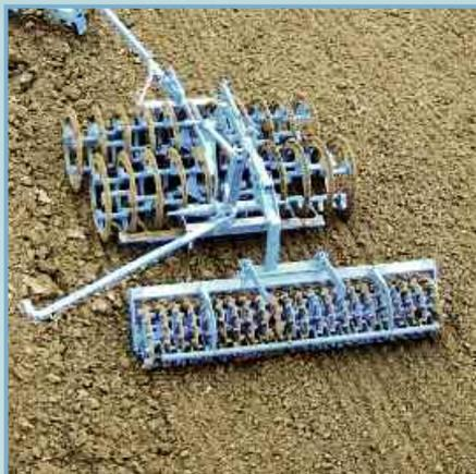
Из-за того, что на почвоуплотнителях LEMKEN рама не располагается по периметру катков, это позволяет формировать компактные комбинации составных агрегатов, работающих в сцепке с уплотнителями. Система соединения позволяет легко и быстро навешивать и снимать дополнительные агрегаты, следующие в сцепке с катками. Такая схема составления агрегатов позволяет присоединенным орудиям работать на хорошо прикатанных почвах.
