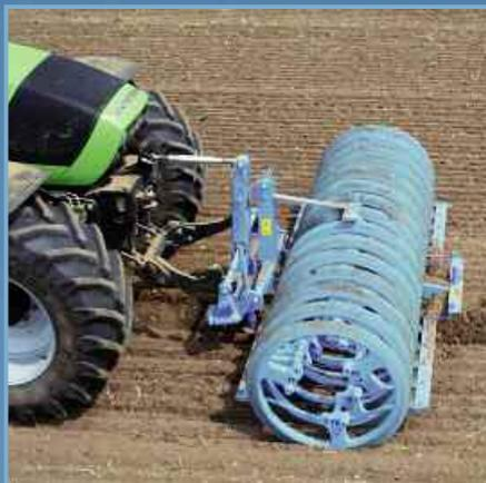
Устройство для фронтального навешивания с фронтальной гидравликой для применения прицепного уплотнителя плуга увеличивает коэффициент использования уплотнителя. Оно подходит ко всем уплотнителям с башней трехточечной навески категории II, также других производителей. Простое устройство регулировки обеспечивает хорошие условия управления при выгодном распределении веса и обеспечивает точность режима эксплуатации.
