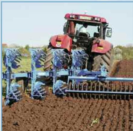
В зависимости от типа почвы и желаемого эффекта воздействия (эффект крошения, обратное прикатывание) ФиксПак может применяться с пластиковым или звездчатым катком.
