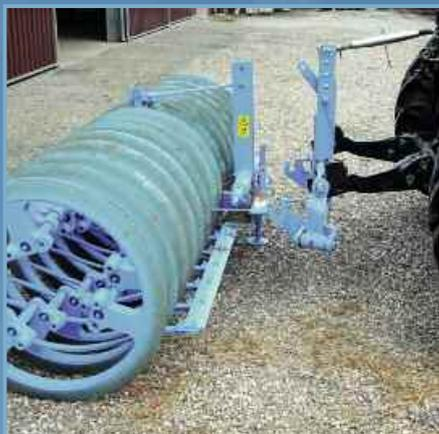
Сменный однорядный кольцевой уплотнитель (WEP), работающий за плугом, при помощи устройства для фронтального навешивания может быстро и просто перенастраиваться для применения во фронтальной навеске. Таким образом, уплотнитель может применяться и при вспашке и при посеве.
