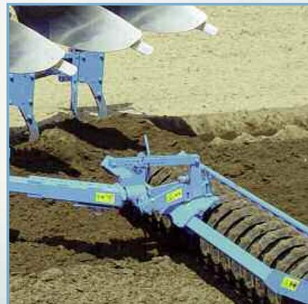
Давление катка на почву можно легко и быстро регулировать в зависимости от почвенных и погодных условий в диапазоне от 400 до 800 кг. Установка требуемого давления выполняется посредством перестановки фиксирующего пальца на пластинах с отверстиями.
