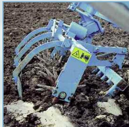
Звездчатый каток в сочетании с регулируемой режущей балкой обеспечивает оптимальное выравнивание и крошение, прежде всего, на средних и тяжелых почвах. При вспашке особо тяжелых почв рекомендуется дополнительное применение ножевого бруса. Он разрушает крупные комья и облегчает последующую предпосевную обработку почвы. Рабочая глубина ножевого бруса регулируется мелкоступенчато.
