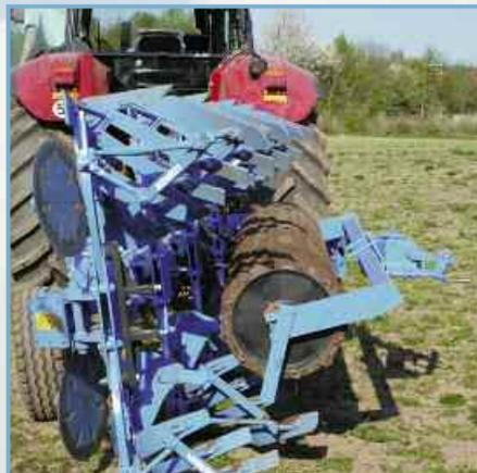
Для транспортировки по дорогам катки уплотнителя и плуг поднимаются, оборачиваются на 90° и механически фиксируются. Затем захват почвоуплотнителя гидравлически складывается параллельно плугу. При вспашке первой борозды ФиксПак не приводит в рабочее положение. Он остается сложенным и зафиксированным в транспортном положении.
